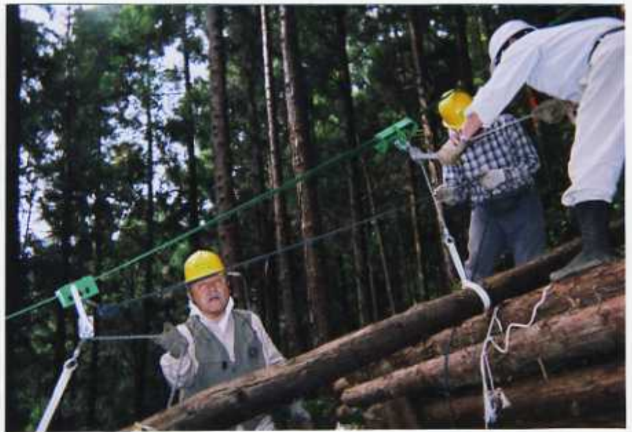
改良の進むTC(テープ・シュート:簡易・材搬出装置)
